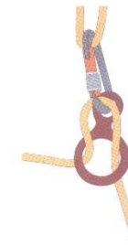
Mittlere Bremse: Der Abseilachter halb eingehängt (Seil läuft durch den Abseilachter und den Karabiner)
